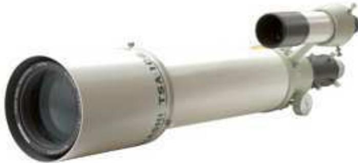
L'objectif de cet instrument est de surveiller l'activité solaire au niveau chromosphérique dans la raie K du Calcium à 393.7 nm (intégration sur le profil au voisinage du coeur de raie)
