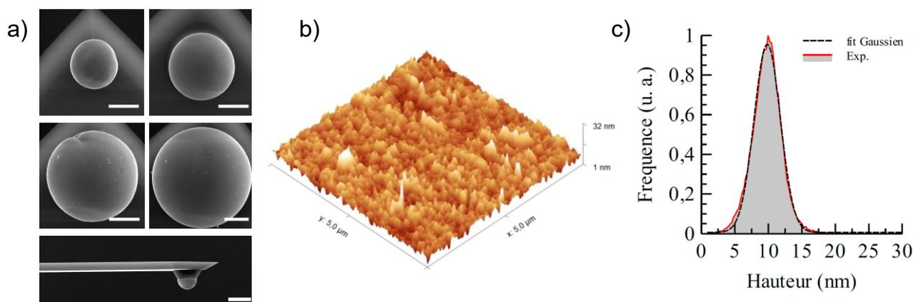
Figure 1 – Micrographies MEB des particules de tungstène greffées sur les leviers AFM (échelle 5  $\mu\text{m}$ ). Cartographie 3D de la surface en verre obtenue par AFM et histogramme des hauteurs des aspérités accompagné d'un ajustement gaussien
