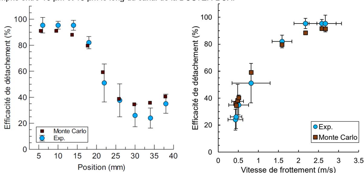
Figure 3 – (Gauche) Efficacités de détachement obtenues pour des particules de 16-18  $\mu\text{m}$  de diamètre le long du canal de la *DUSTER-BOX* et calculs Monte-Carlo correspondants. (Droite) Efficacités de détachement expérimentales et calculs Monte-Carlo en fonction de la vitesse de frottement.
