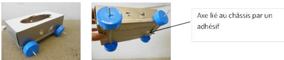
**Figure 11** : Exemples de prototypes 2, liaison pivot axe/roue.
