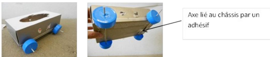
Figure 11 : Exemples de prototypes 2, liaison pivot axe/roue.
