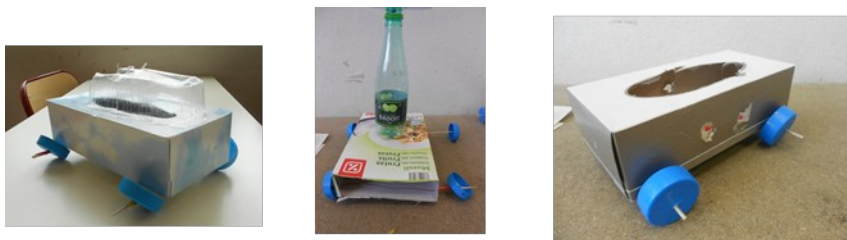
Figure 7 : Exemples de prototypes 2 avec frottement au niveau de la liaison pivot.
