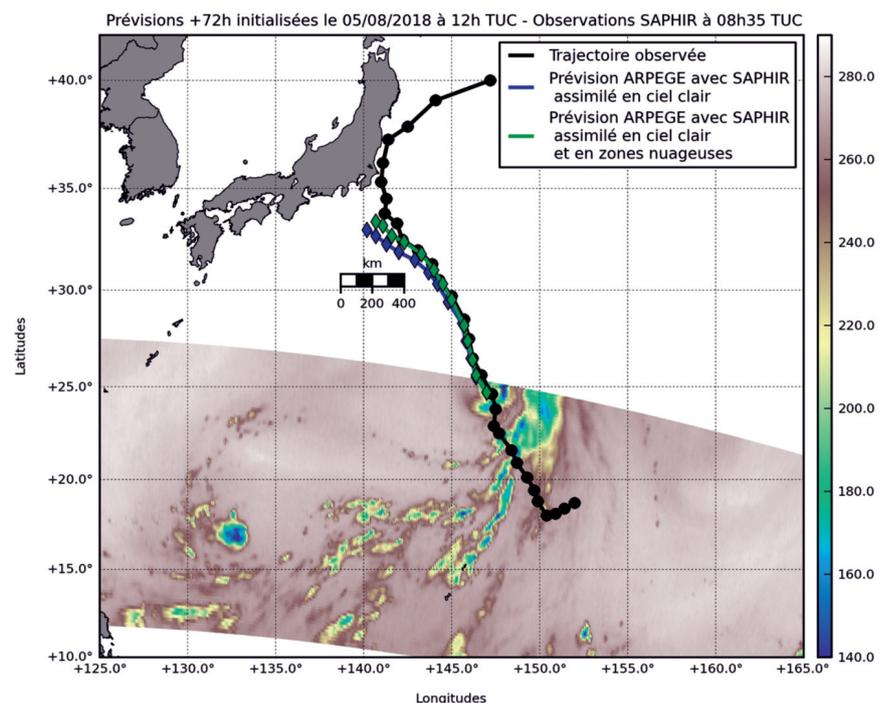
Figure 6. Position de l'œil du cyclone *Shanshan* (bassin du Pacifique Nord-ouest), toutes les 6 heures (courbe noire). Exemple de trajectoires prévues par le modèle Arpege jusqu'à 72 heures d'échéance, avec (courbe verte) et sans (courbe bleue) observations nuageuses de Saphir dans le système d'assimilation.
