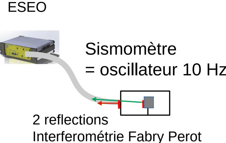
3 oscillateurs 10 Hz omnidirectionnels
