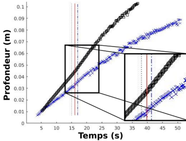
Figure 5 : Évolution de la profondeur d'ablation en fonction du temps pour les deux cas présentés en Fig. 4. Les carrés noirs correspondent au cas où  $V_j = 4,48$  m/s. Le "pool-effect" apparaît entre la ligne en pointillés noirs et la ligne continue rouge. Les croix bleues correspondent au cas  $V_j = 2,33$  m/s, Le "pool-effect" apparaît entre la ligne continue rouge et la ligne discontinue bleue. Un agrandissement est effectué sur la zone suivant le "pool-effect".
