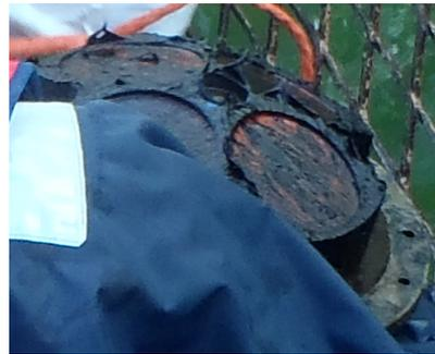
Figure 11 : Etat du câble Adcp et des faisceaux de l'Adcp après 175 jours de fonctionnement
