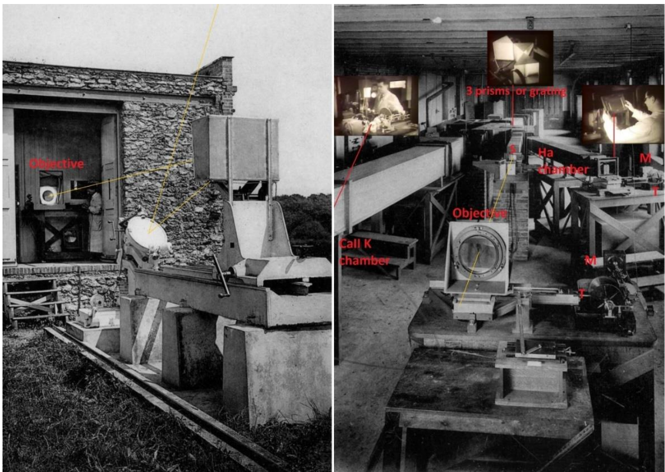
Figure 21. Le spectrohéliographe quadruple (1909) avec le coélostat (à gauche) et l'objectif d'imagerie (focale de 4 m). On voit la chambre Call K (bras gauche, schéma optique de la Figure 22 ), la chambre H \alpha (bras droit, schéma sur Figure 22 ), les moteurs électriques (M) déplaçant l'objectif et les plaques photographiques, et les « transformateurs de vitesse » associés (T, détails mécaniques sur la Figure 23 ). (S) est la fente d'entrée commune. Crédit observatoire de Paris.
