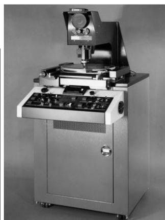
Figure 20 : Micro-photomètre Joyce-Loebl, Micro-densitomètre PDS 1010 de Perkin Elmer piloté par un ordinateur PDP 8 (DIGITAL)
