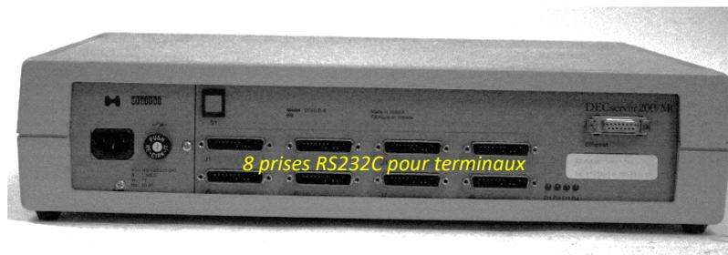
Figure 46 : Un serveur de terminaux « DecServer » 100 de Digital à 8 prises série RS232C. L'appareil était connecté au coaxial Ethernet épais via un câble AUI et une prise vampire H4000.
