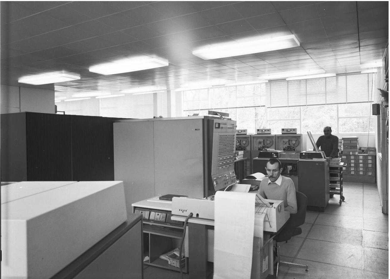
Figure 13 : IBM 360/65 du centre de calcul de l'INAG à l'Observatoire de Meudon dans les années 70
