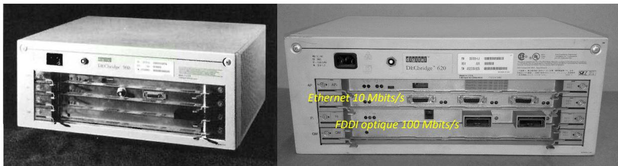
Figure 45 : Les ponts FDDI/Ethernet de DIGITAL équipant Meudon (à gauche, DecBridge 520, à droite, DecBridge 620), donnant naissance à de nombreuses branches Ethernet 10 Mbits/s filtrées
