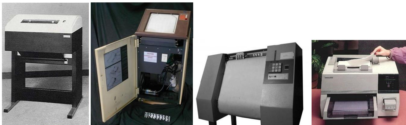
**Figure 26 :** Imprimante alphanumérique rapide DIGITAL LP02, imprimante graphique électrostatique VERSATEC, traceur de courbes BENSON, imprimante LASER Postscript DIGITAL LN03, identiques à ceux attachés au VAX 11/780 de Meudon via des lignes série RS232C
