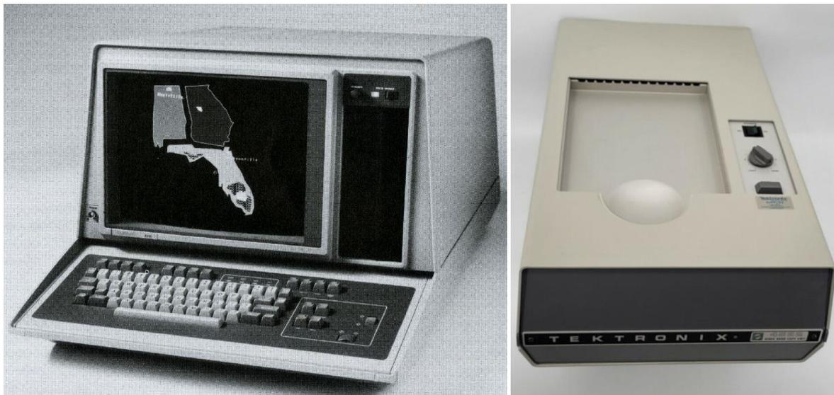
Figure 27 : Terminal graphique TEKTRONIX 4112 et imprimante thermique de recopie d'écran TEKTRONIX
