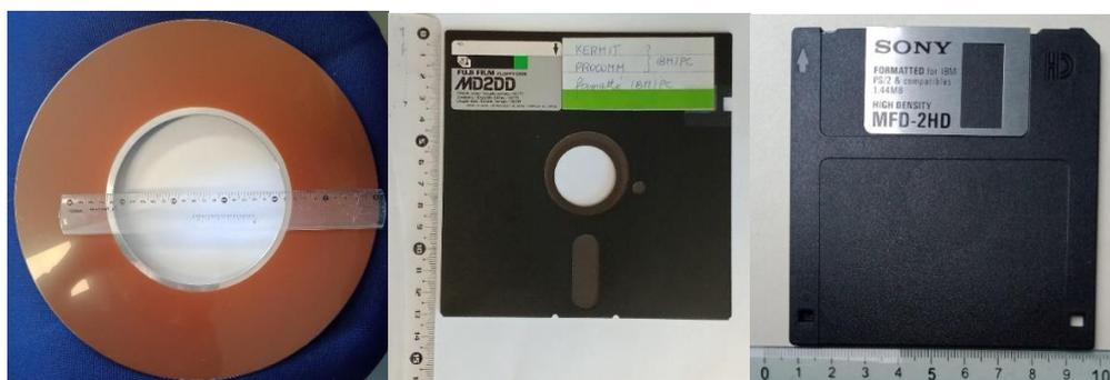
Figure 58 : Stockage des ordinateurs : disques amovibles du début des années 80. A gauche : disque 14 pouces de 10 Mo pour PDP 11. Au milieu : disquette IBM PC de 360 Ko en 5 pouces ¼. A droite : disquette IBM PC de 1.44 Mo en 3 pouces ½.
