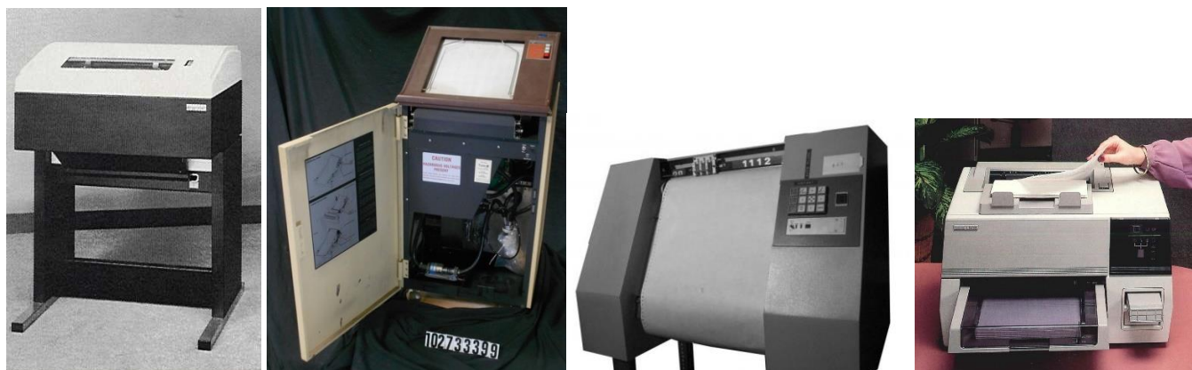
Figure 26 : Imprimante alphanumérique rapide DIGITAL LP02, imprimante graphique électrostatique VERSATEC, traceur de courbes BENSON, imprimante LASER Postscript DIGITAL LN03, identiques à ceux attachés au VAX 11/780 de Meudon via des lignes série RS232C
