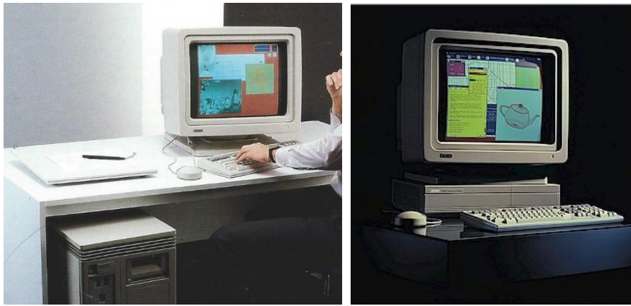
Figure 36 : Le Local Area VAX Cluster (LACV) de partage des ressources sur Ethernet permettait la mise en commun d'espaces disque avec des VAX Station II/GPX (1986, à gauche) ou des DEC Station 3100 (1990, à droite)
