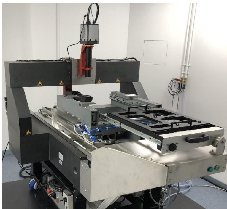
Figure 22 : Machine NAROO (caméra 2048 x 2048 en haut), cliché Vincent Robert, IMCCE/OP. La caméra ANDOR sCMOS est immobile, le porte plaque est muni de moteurs micrométriques rapides en (x, y)
