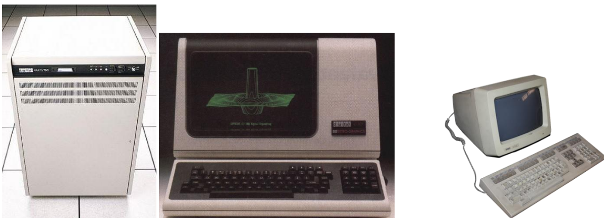
Figure 29 : VAX 11/750 (1980), le modèle du « VAX spatial » du DESPA, un terminal VT100 Retro-Graphics de DIGITAL ENGINEERING émulant le poste graphique monochrome TEKTRONIX 4010, et seconde génération de terminal alphanumérique, le VT220 de DIGITAL
