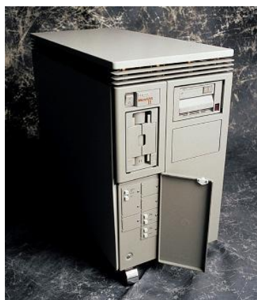
Figure 35 : Principe du Local Area VAX Cluster (partage de ressources de stockage sur Ethernet) et le MicroVAX II de DIGITAL à droite. Le protocole LAVC était très utile pour les stations de travail sous VMS en réseau car elles pouvaient partager l'espace disque des VAX et même « booter » au travers du réseau local.
