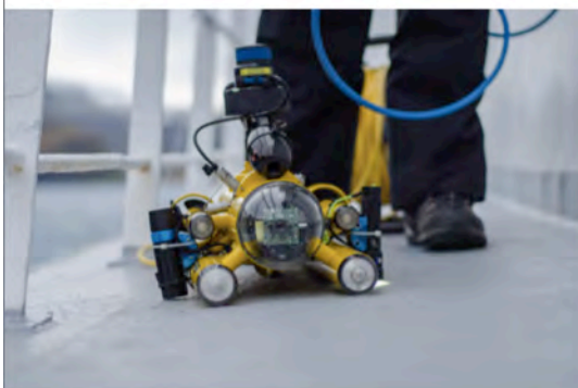
Figure 9. Poste de pilotage du ROV depuis la passerelle de la Curieuse , côté bâbord (gauche haut), armement du ROV avec la caméra HD Paralenz, un phare, le pinger pour sa localisation par le transpondeur (gauche bas), et déploiement du ROV depuis bâbord (droite).
