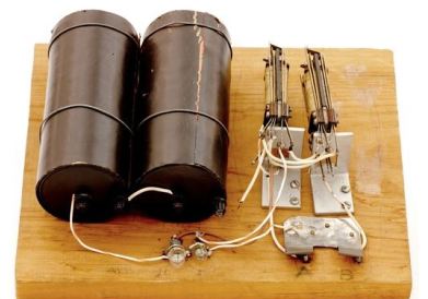
FIGURE 4 : Réplique du calculateur binaire de George STIBITZ, 1937. Crédit photo : compute-rhistory.org .
