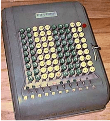
FIGURE 15 : Le comptomètre de FELT. Source : history-computer.com .
