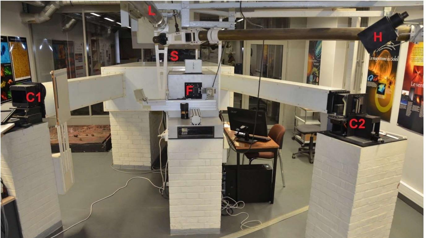
**Figure 1.** Spectrohéliographe de Meudon. C1 et C2 : anciennes chambres photographiques de 3.0 m pour Call K et H $\alpha$ . S : spectrographe (contient la chambre CCD de 0.4 m, le réseau et le collimateur de 1.3 m). H = spectrohélioscope visuel escamotable à prismes rotatifs. L = porte lune de densité 1 couplé à l'objectif. F : fente du spectrographe (soleil de 37.2 mm).
