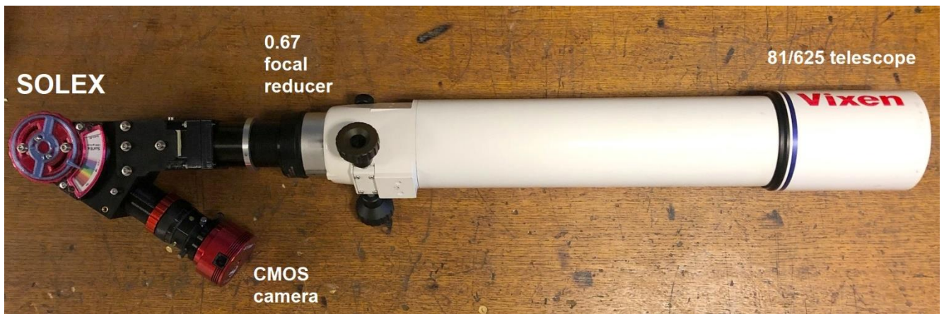
Figure 5 : Le SOLEX de Meudon : il utilise un réfracteur de focale 625 mm ; le diamètre de l'image solaire est plus grand que la fente de 4.5 mm du SOLEX et doit être réduit. Par conséquent, nous utilisons un réducteur focal de grandissement 0,67 X pour obtenir une distance focale équivalente de 420 mm.
