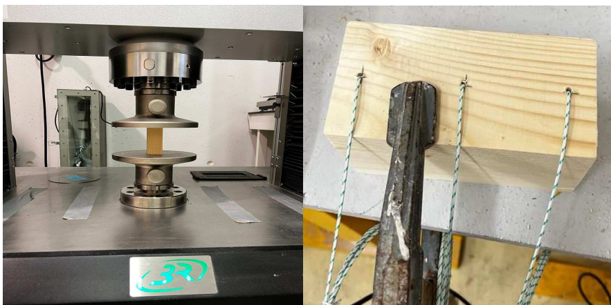
FIGURE 2. A gauche : Essais de compression pour les essais sur le bois de Sapin (section S0) réalisé sur une presse électromécanique 3R de capacité 300KN.
