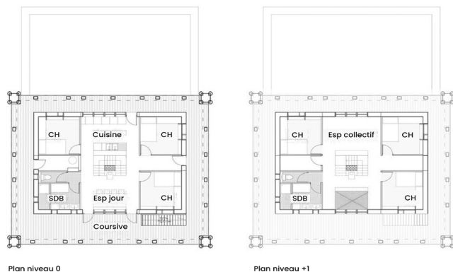
Figure 5. En se basant sur les surfaces allouées aux différents espaces dans les studios présents dans l'unité de logement existante à BSA, IMAGO repense une nouvelle configuration en vue d'optimiser la fabrication des modules et les futurs usages, et d'encourager la cohabitation et une dynamique collective au sein du logement.
