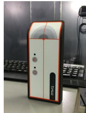
Figure 3. Banc de mesure de SAR utilisé & Mobile de référence (MVG [1])
