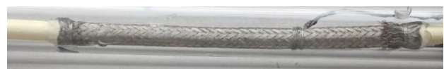
Figure 3 Schéma et cliché d'un échantillon avec tresse. À noter les extrémités de tresse rétractées et recouvertes de graisse isolante.
