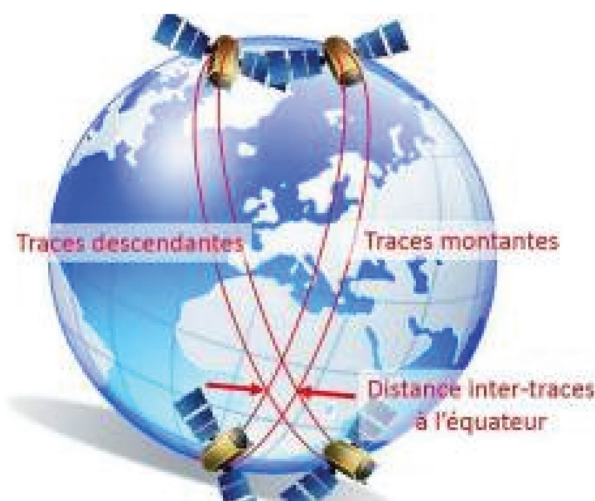
Figure 1. Trajectoire d'un satellite autour du globe. Notions de traces et d'inter-traces.
