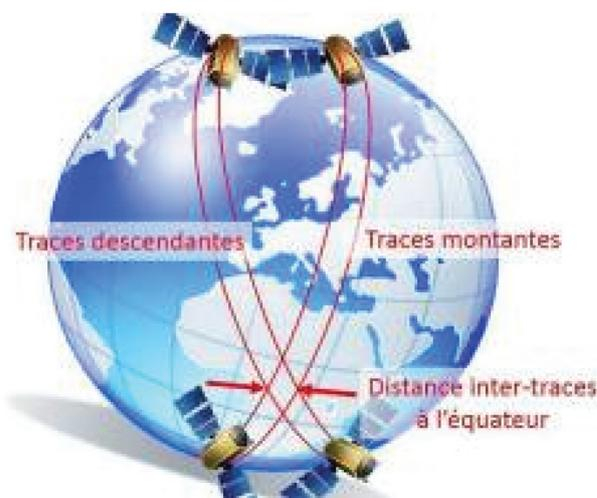
Figure 1. Trajectoire d'un satellite autour du globe. Notions de traces et d'inter-traces.
