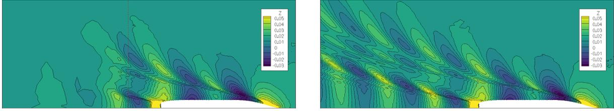
FIGURE 4 – KCS, élévation de la surface libre avec boîte de limitation à  $0,3L$  derrière le bateau (gauche) et  $2L$  derrière le bateau (droite). Seuil  $T_{rH} = 0,05L$ . La ligne en pointillé indique le bord arrière de la boîte limitante.
