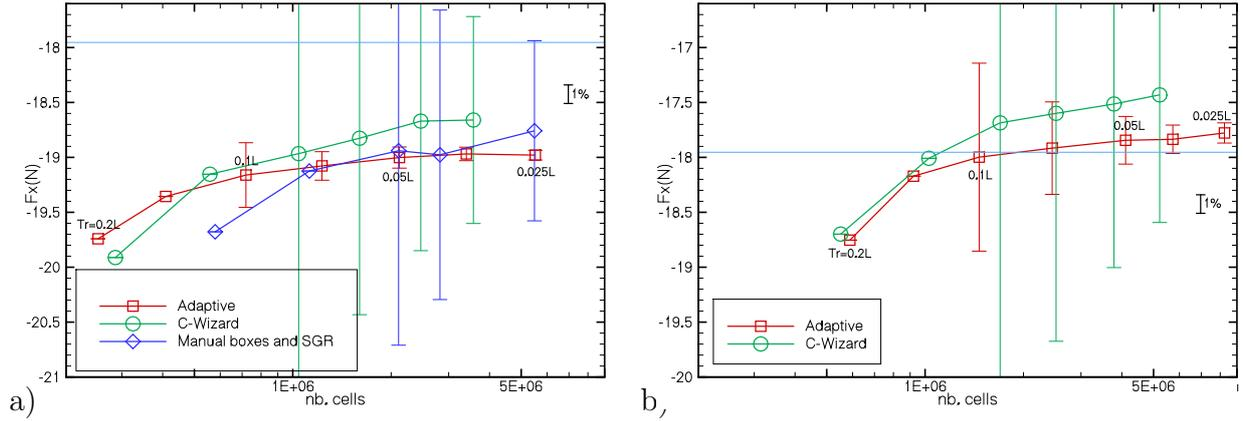
FIGURE 9 – Résistance du KVLCC2, convergence en maillage pour la loi de paroi (a) et la paroi résolue (b).
