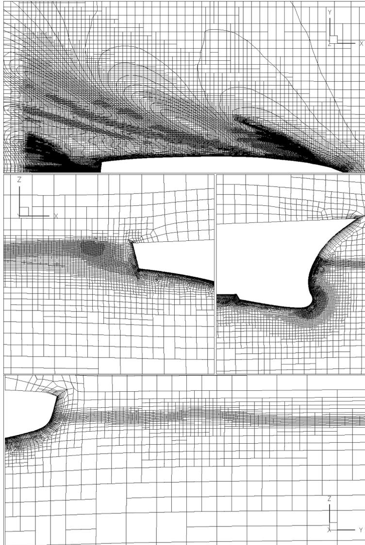
FIGURE 1 – Un maillage adapté selon le protocole de la section III. De haut en bas : surface libre, détails du plan de symétrie  $Y$ , coupe  $X$  à l'arrière du bateau. Le cas est le DTMB 5415 à  $Fr = 0,41$  de la section IV – 2, avec  $T_{r,H} = 0,07$ .
