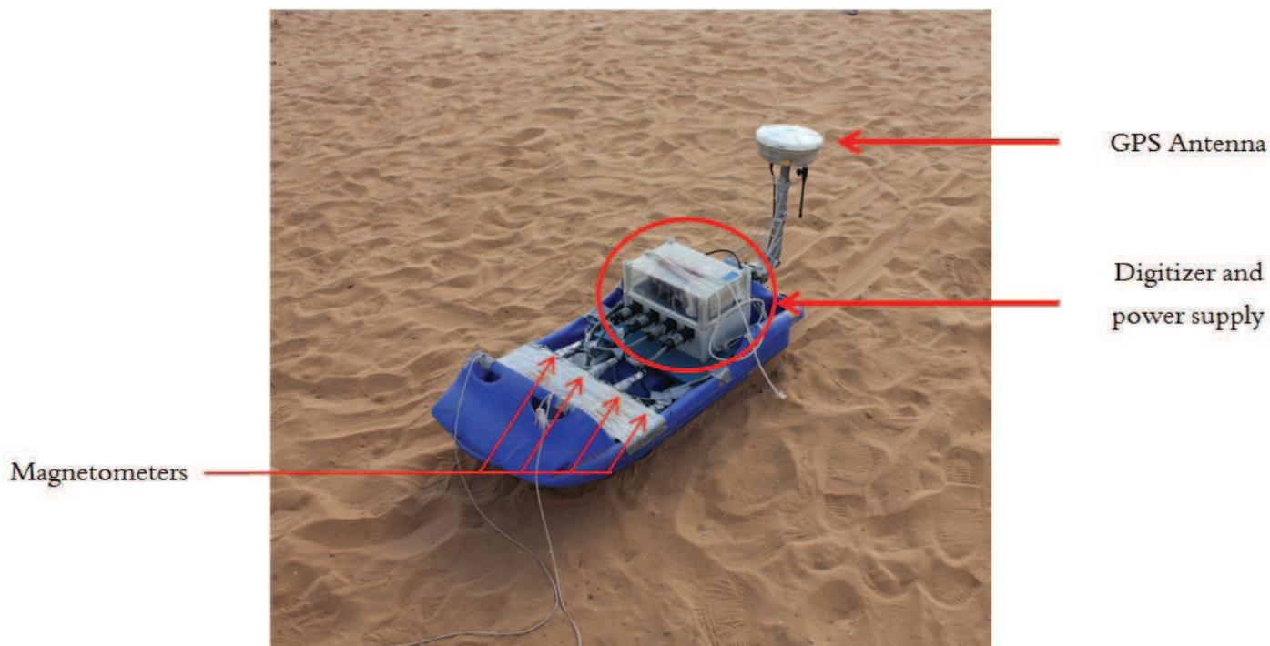
Figure 13: The «Sledge» device
