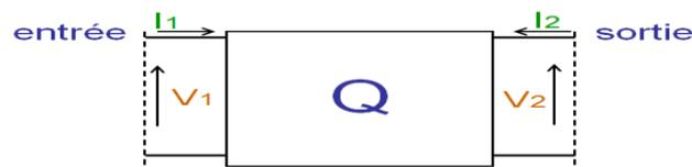
Figure IV.3 : Quadripôle avec ces accès
