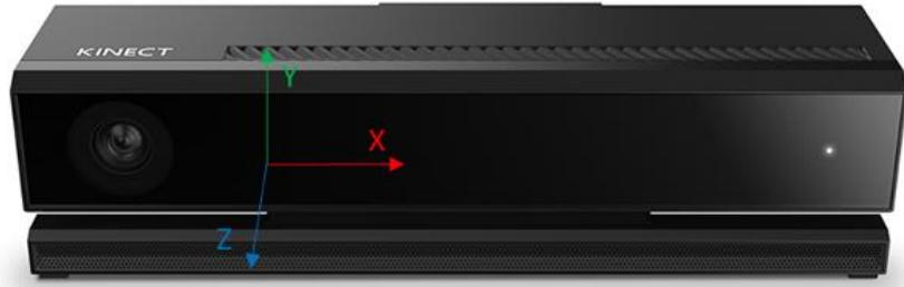
Figure 44 : Plan de référence des données fournies par la Kinect : Plan Kinect.
