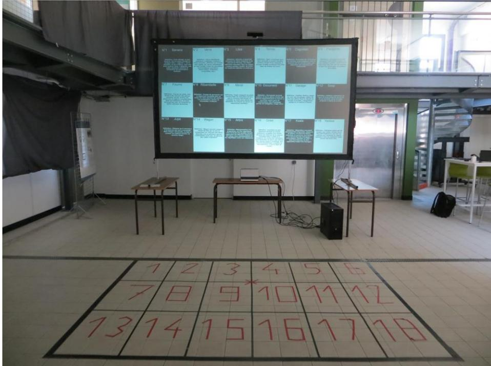
Figure 39 : Photo de l'installation de l'expérience concernant la caractérisation des mouvements de la tête lors d'une tâche de consultation d'un affichage de grand format à l'aide d'un dispositif d'head tracking.
