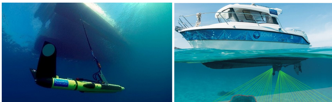
Figure 9 Imagerie par sonar latéral (gauche) et sondeur multifaisceaux (droite) (©Andromède Océanologie).
