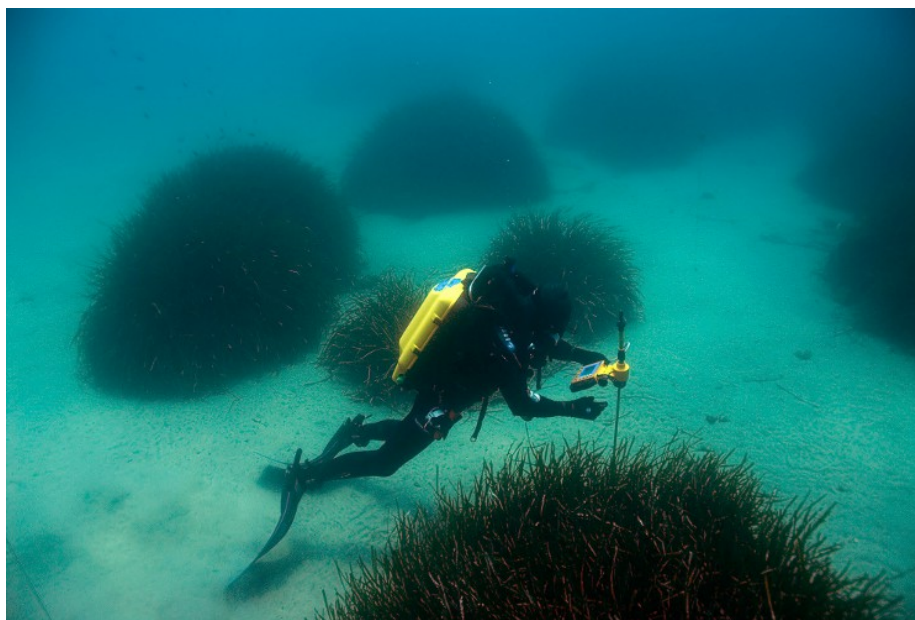
Figure 13 Plongeur entrain de cartographier un herbier de posidonie à l'aide d'un télémètre acoustique (©Andromède Océanologie).
