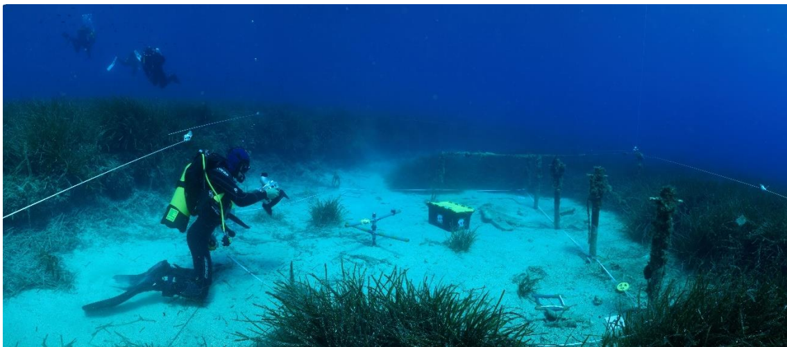
Figure 1. Installation de l'expérience de photogrammétrie – Calvi, 2017
