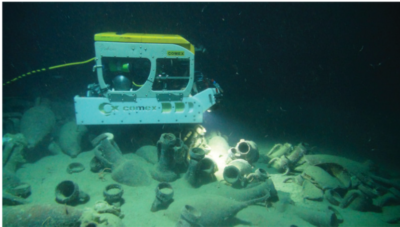
Figure 14 ROV3D : un robot d'acquisition photogrammétrique pour l'archéologie sous-marine (Drap et al., 2015).
