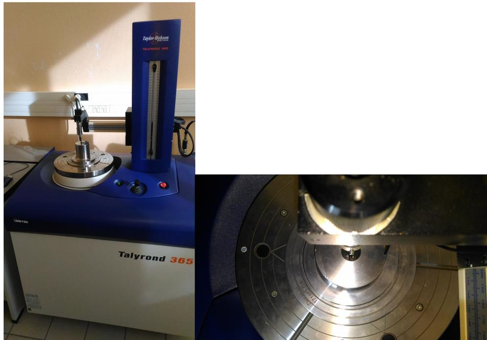
FIGURE E.2 – Équipement *TalyRond* pour des mesures de surface avec la Tuyère n°8 en cours de mesure sur la platine rotative. La seconde photographie est une image rapprochée de la tuyère qui rend la visualisation du dispositif de palpation possible un niveau du col pouvant évoluer verticalement en hauteur à l'aide du bras automatisé.
