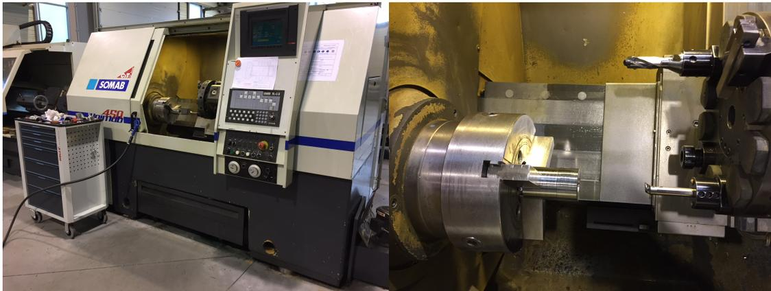
FIGURE D.1 – Tour utilisé pour la fabrication des tuyères (à gauche) et un exemple de pièce en cours d'usinage (à droite) avec l'outil de perçage et la pointe de carbure utilisée pendant le tournage (DELTAFLUID™, matériel : OPTIMAB SOMAB 450).
