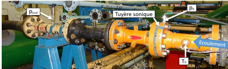
FIGURE H.1 – Photographie annotée du montage pour la mesure du ratio de pression critique au niveau de l'indice n° 13 sur le schéma de la Figure 2.13 de l'installation haute pression de Cesame.
