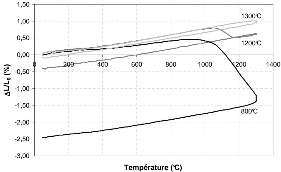
**Figure 5.3** : Effet du frittage et de la désorption de  $Y_2O_3$  sur les courbes de dilatation obtenues par TMA (après traitement thermique sous air ambiant à 800°C, 1200°C pendant 10 heures ou 1300°C pendant 5 heures).
