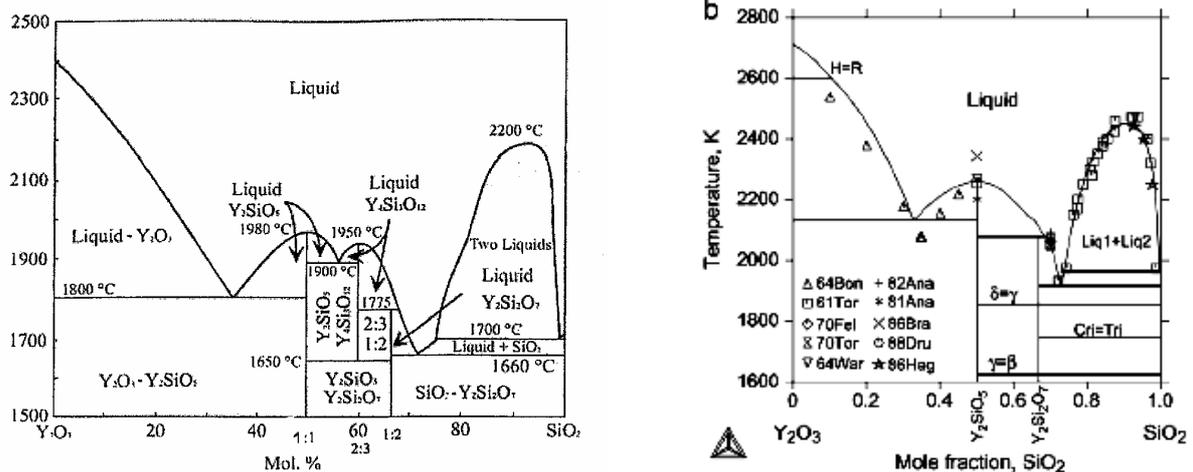
**Figure 4.1 :** Diagramme de phases  $\text{Y}_2\text{O}_3$ - $\text{SiO}_2$  (a/ [Toropov 1972], b/ [Mao 2008]).
