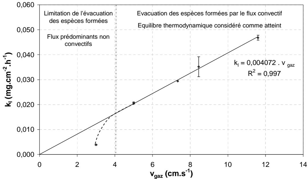
**Figure 5.4 :** Variation de la constante de volatilisation  $k_1$  en fonction de la vitesse des gaz  $v_{\text{gaz}}$  ( $T = 1200^\circ\text{C}$ ,  $P_{\text{H}_2\text{O}} = 50 \text{ kPa}$ ,  $P_{\text{tot}} = P_{\text{atm}}$ ).
