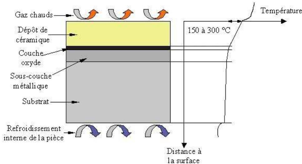
**Figure 5** : Schéma d'une barrière thermique. (L'échelle dimensionnelle des différentes couches n'est pas respectée. A droite, le profil de température est schématisé à travers les couches) [Tricoire 2005].
