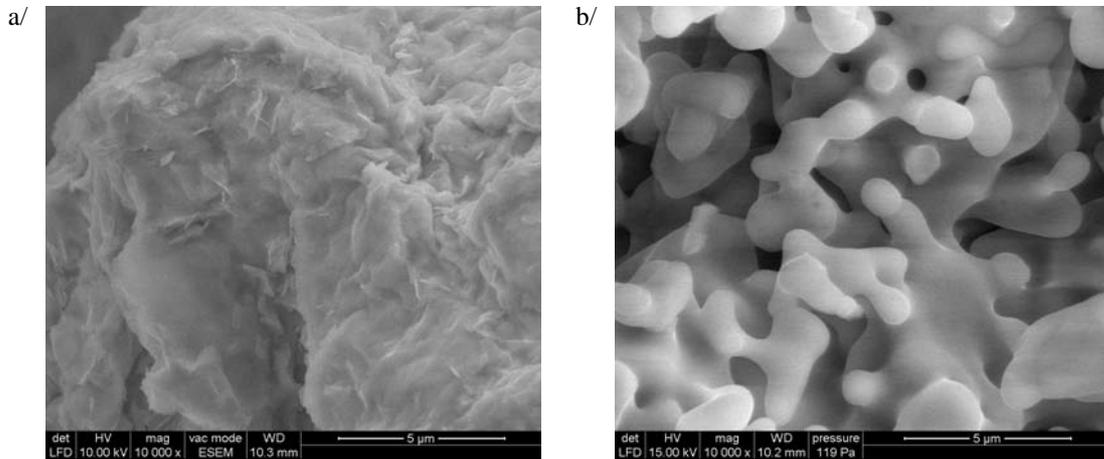
**Figure 4.4 :**  $Y_2SiO_5$  a/ après calcination à 1200°C pendant 10 heures sous air ambiant et b/ après frittage à 1500°C pendant 5 heures sous air ambiant.
