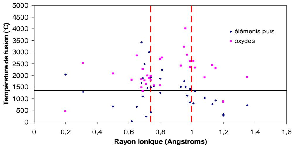
**Figure 20** : Evolution de la température de fusion des éléments purs et de leurs oxydes en fonction du rayon ionique de l'élément pur. Les traits pointillés rouges délimitent le domaine intéressant, le trait noir représente la température d'utilisation.
