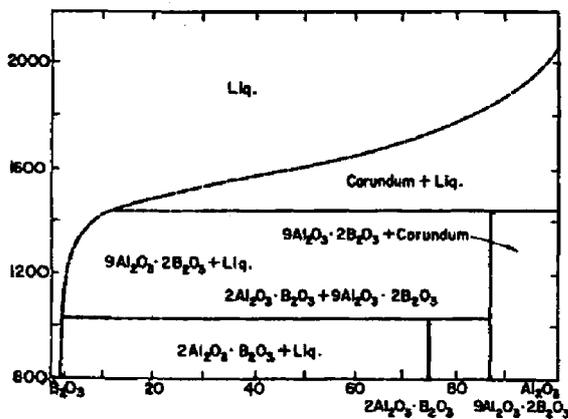
Figure 2 : Diagramme de phases  $\text{B}_2\text{O}_3\text{-Al}_2\text{O}_3$ .
