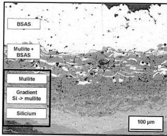
**Figure 12** : Gradient de composition Si → mullite intégré dans le dépôt de référence à base de BSAS.
