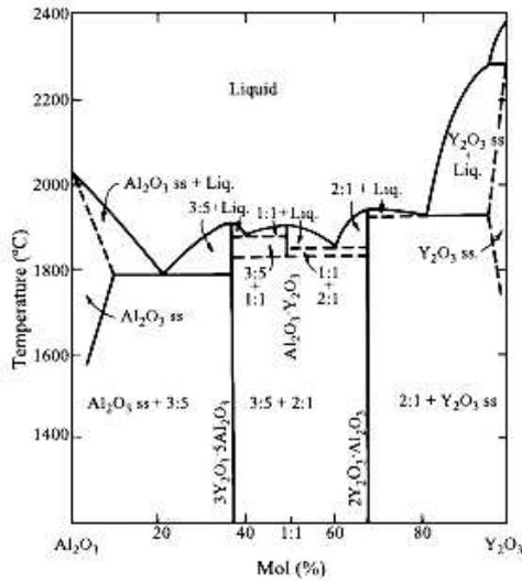
**Figure 18** : Diagramme de phases  $\text{Al}_2\text{O}_3\text{-Y}_2\text{O}_3$ .
