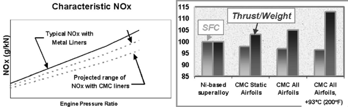
**Figure 1** : Avantage des composites à matrice céramique dans les émissions de NO<sub>x</sub> (gauche) et dans la consommation de carburant (SFC) et dans le rapport force de propulsion/poids (droite) [Spitsberg 2004].
