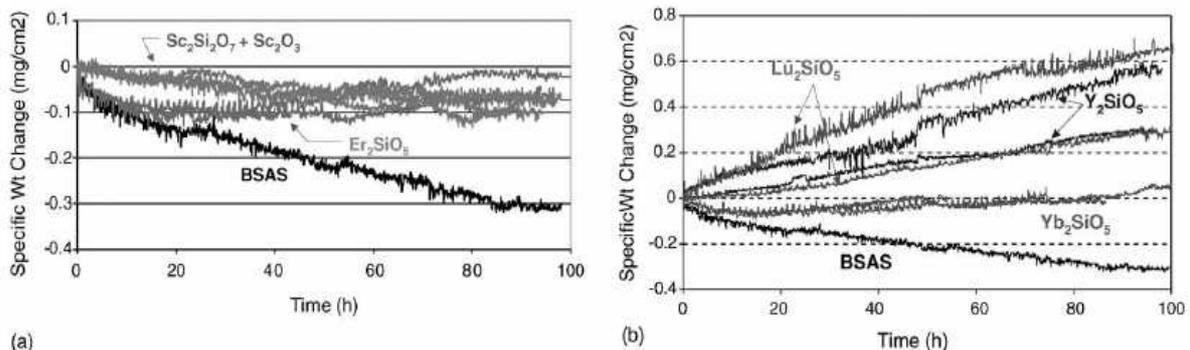
**Figure 2.5** : Comparaison de la stabilité des silicates de terre rare à celle du BSAS (à 1500°C sous 50 kPa d'eau à  $P_{\text{atm}}$ ,  $v_{\text{gaz}} = 4,4$  cm.s<sup>-1</sup>) [Lee 2005b].
