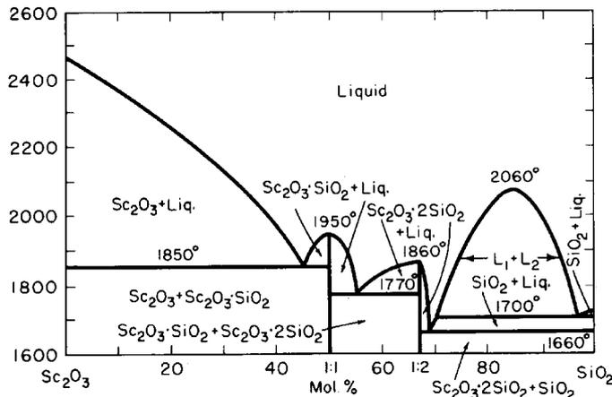
**Figure 23** : Diagramme de phases  $\text{Sc}_2\text{O}_3 - \text{SiO}_2$ .
