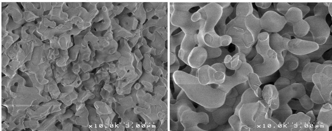
**Figure 4.2 :**  $\text{Y}_2\text{SiO}_5$  fritté sous air ambiant à a/ 1400°C pendant 5 heures et b/ 1500°C pendant 5 heures.
