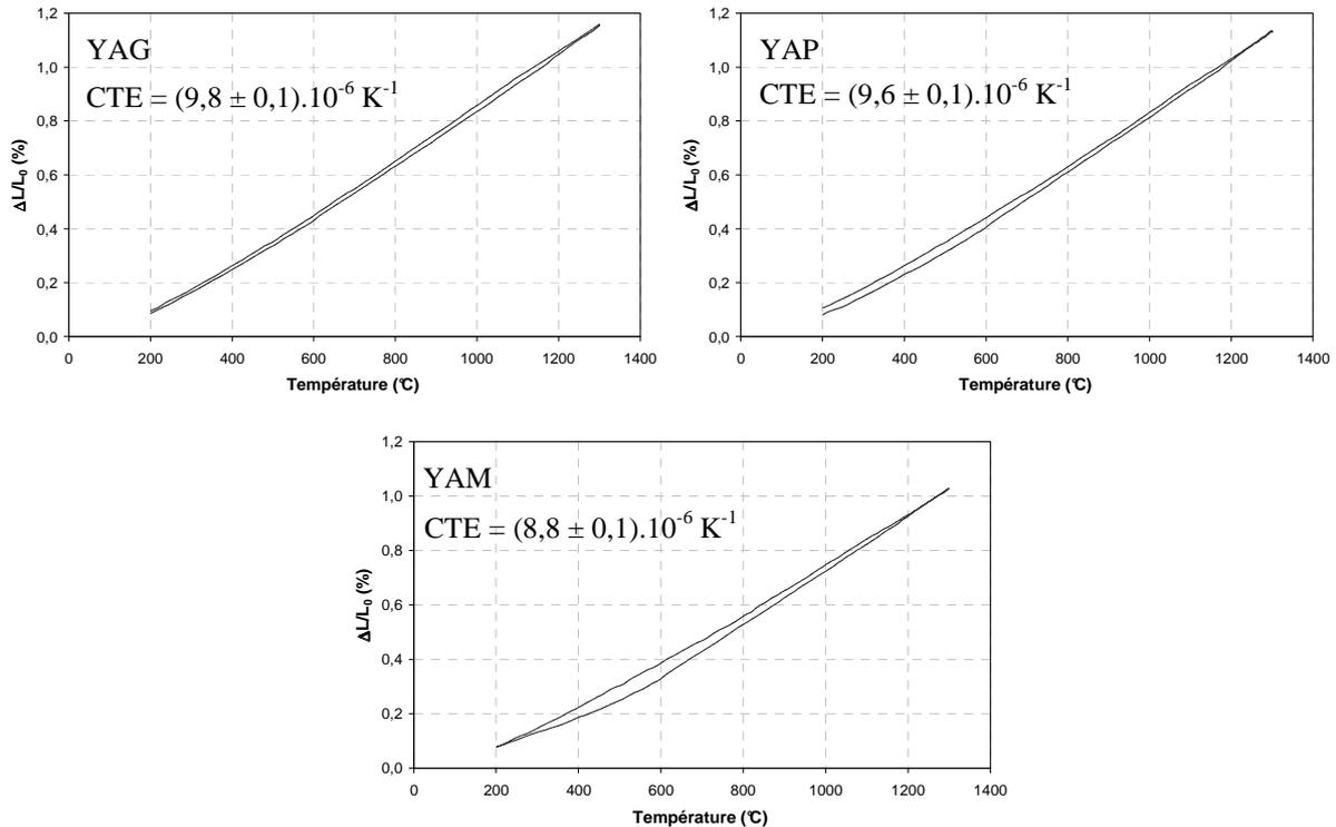
**Figure 4.9** : Courbes de dilatation du YAG, YAP et YAM en fonction de la température (obtenues par TMA).
