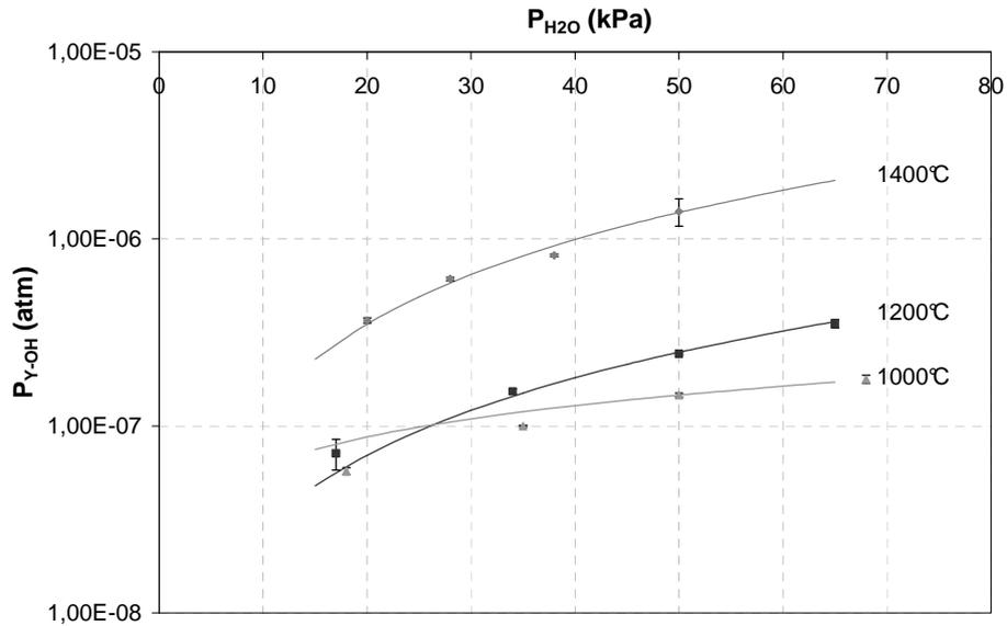
**Figure 5.9** : Comparaison des valeurs des pressions partielles de Y-OH obtenues expérimentalement (symboles) ( $P_{\text{tot}} = P_{\text{atm}}$ ,  $v_{\text{gaz}} = 5 \text{ cm.s}^{-1}$ ) et par calculs thermodynamiques (courbes).
