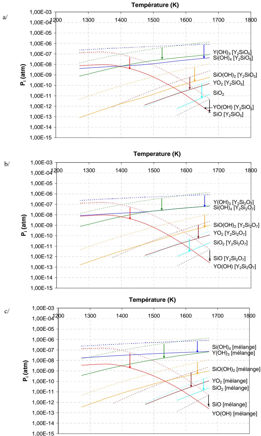
**Figure 5.13 :** Stabilité thermochimique établie à partir d'une approche thermodynamique de a/  $Y_2SiO_5$ , b/  $Y_2Si_2O_7$  et c/  $Y_2SiO_5 + Y_2Si_2O_7$  sous air humide ( $P_{Ar} = 40$  kPa,  $P_{O_2} = 10$  kPa et  $P_{H_2O} = 50$  kPa) ( $P_i$  calculées avec Gemini 2).
