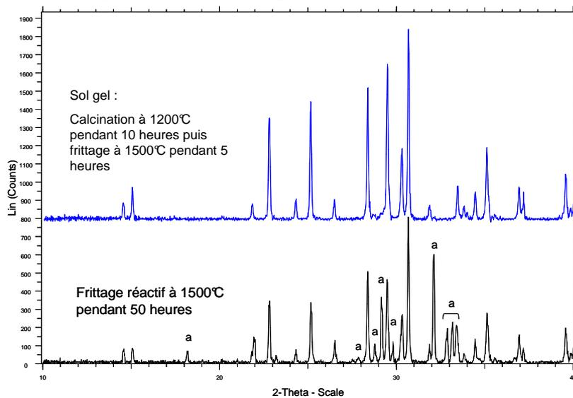
**Figure 4.5 :** Diffractogrammes de  $Y_2SiO_5$  synthétisés par frittage réactif sous air ambiant à 1500°C pendant 50 heures ou par voie sol gel (calcination à 1200°C pendant 10 heures sous air suivie d'un frittage sous air ambiant à 1500°C pendant 5 heures).
