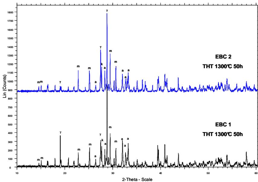
**Figure 6.12** : Diffractogrammes de l'EBC 1 et de l'EBC 2 sur substrat SiC/SiC après recuit à 1300°C pendant 50 heures sous air ambiant (m =  $Y_2SiO_5$ , a = apatite, k =  $Y_2Si_2O_7$  keiviite,  $\gamma$  =  $Y_2Si_2O_7$ - $\gamma$ ).
