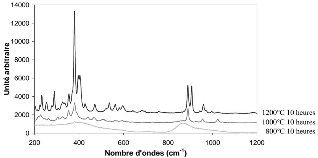
**Figure 4.3 :** Spectres Raman de  $Y_2SiO_5$  calciné à 800, 1000 ou 1200°C pendant 10 heures sous air ambiant.
