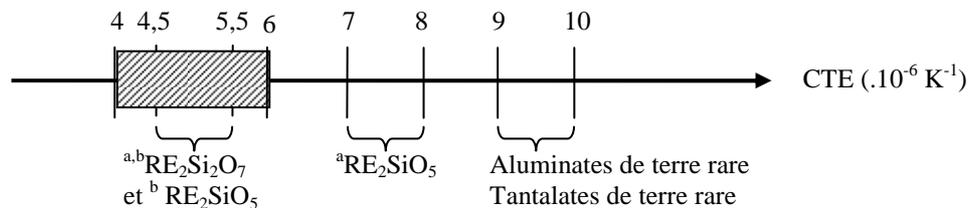
**Figure 4.14** : Récapitulatif des coefficients de dilatation thermique des matériaux sélectionnés en fonction des procédés d'élaboration : a : frittage réactif (présence de  $\text{RE}_2\text{O}_3$  ou d'apatite résiduels pour  $\text{RE}_2\text{SiO}_5$ ); b : sol gel.
