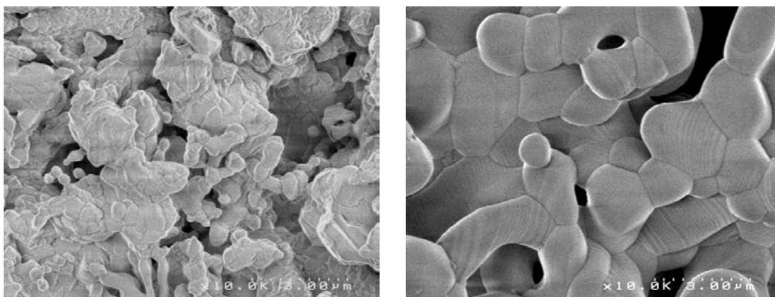
**Figure 4.11** :  $TaYO_4$  fritté sous air ambiant a/ à 1300°C pendant 50 heures et b/ à 1500°C pendant 5 heures.
