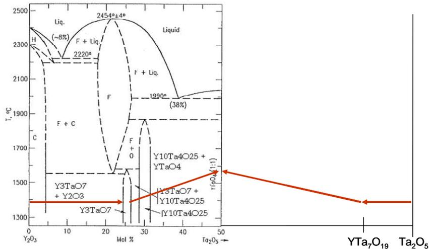
**Figure 4.12** : Diagramme de phases  $Y_2O_3 - Ta_2O_5$  et chemins intermédiaires de réaction de formation progressive du composé défini  $TaYO_4$  à partir d'un mélange de  $Ta_2O_5$  et  $Y_2O_3$  (→).
