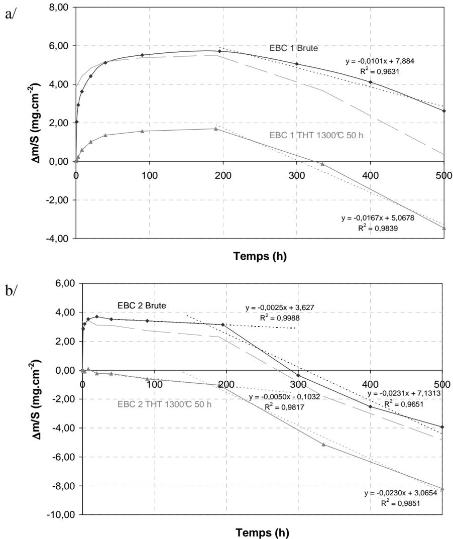
**Figure 6.15** : Variation de masse surfacique enregistrée lors des essais de corrosion menés à 1400°C sous 50 kPa d'eau à  $P_{atm}$  ( $v_{gaz} = 5 \text{ cm.s}^{-1}$ ) sur les EBC a/ 1 et b/ 2 brutes et traitées thermiquement à 1300°C pendant 50 heures sous air ambiant.
