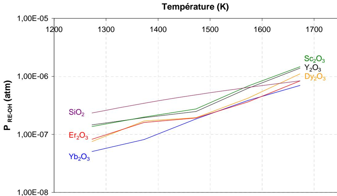
**Figure 5.12** : Comparaison des sommes des pressions partielles des différentes espèces hydroxydes à l'équilibre au-dessus de chaque oxyde de terre rare solide ( $P_{H_2O} = 50$  kPa,  $P_{tot} = P_{atm}$ ).
