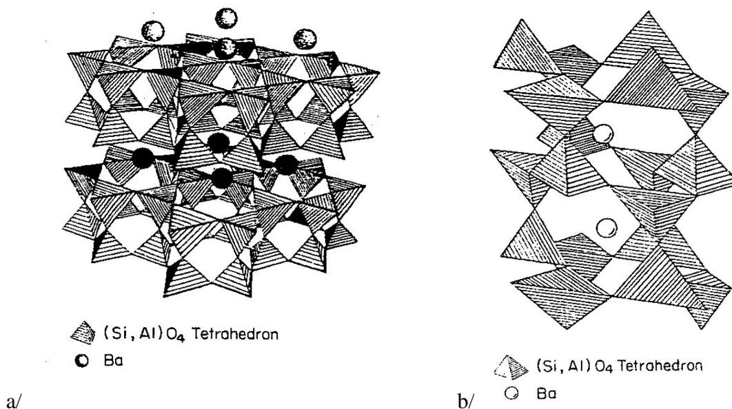
**Figure 9** : Structure cristallographique a/ de l'hexacelsian et b/ du celsian du BAS.
