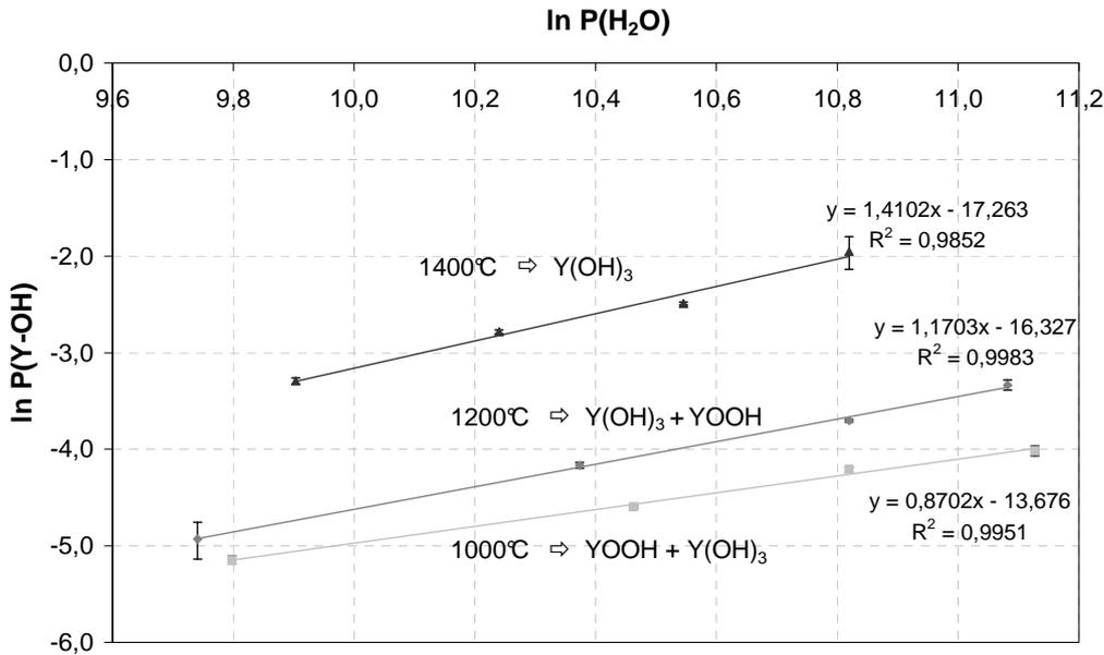
**Figure 5.7** : Détermination des ordres partiels réactionnels associés à  $\text{H}_2\text{O}$  afin d'identifier la nature des espèces hydroxydes à l'origine de la volatilisation de  $\text{Y}_2\text{O}_3$  à haute température ( $P_{\text{tot}} = P_{\text{atm}}$ ,  $v_{\text{gaz}} = 5 \text{ cm.s}^{-1}$ ) ( $P$  en Pa).
