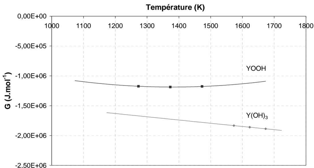
**Figure 5.8** : Détermination de l'enthalpie libre de formation de YOOH et de Y(OH)<sub>3</sub>.
