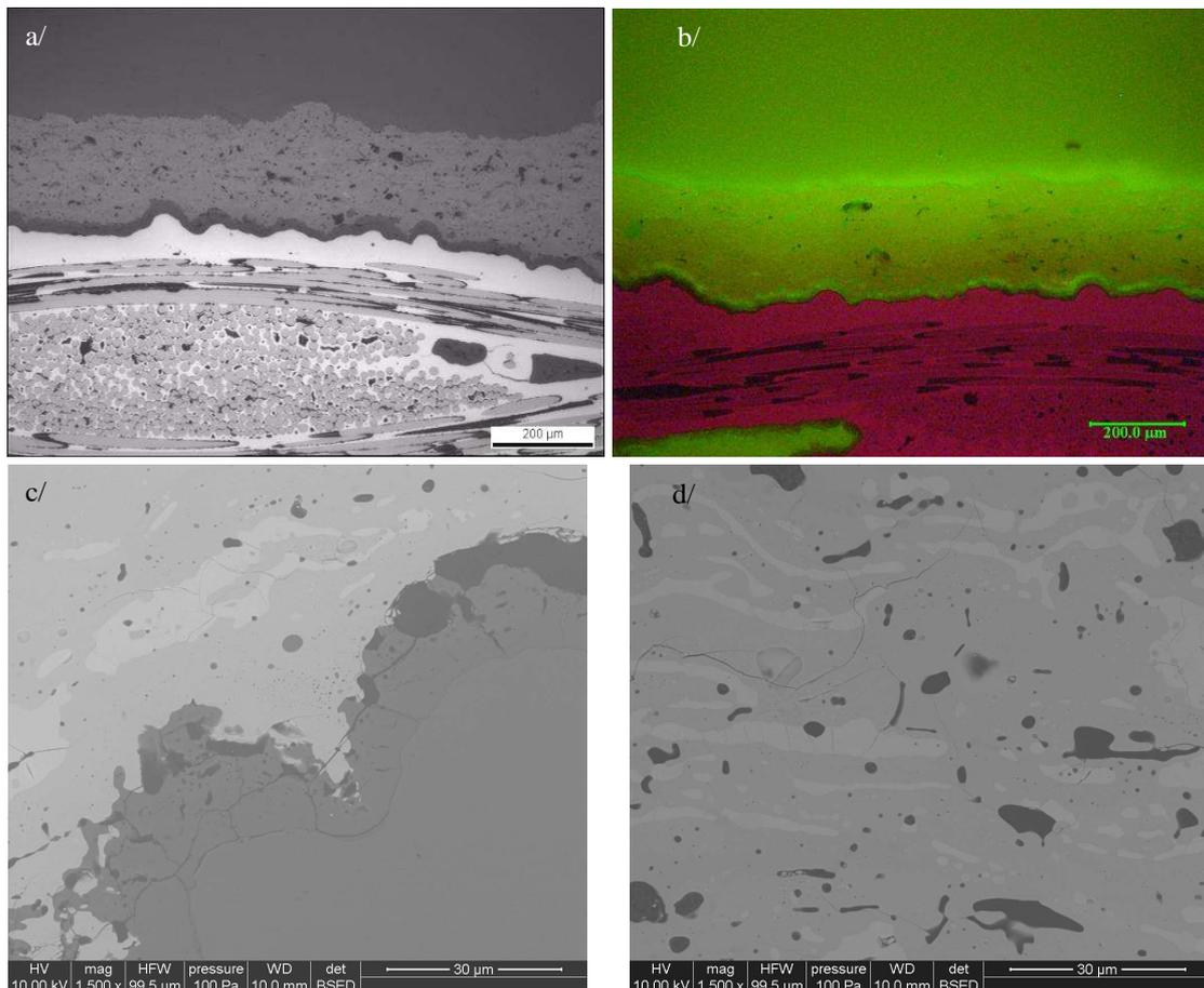
**Figure 6.18** : Section de l'EBC 1 brute après 500 heures de corrosion à 1400°C sous 50 kPa d'eau à  $P_{atm}$  ( $v_{gaz} = 5 \text{ cm.s}^{-1}$ ) a/ vue d'ensemble (MO) et b/ vue d'ensemble (fluorescence) ; c/ interface dépôt / substrat ; d/ détail du dépôt.
