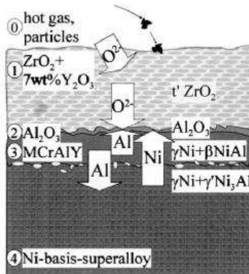
**Figure 7** : Mécanismes d'oxydation de la sous-couche [Stöver 1999].
