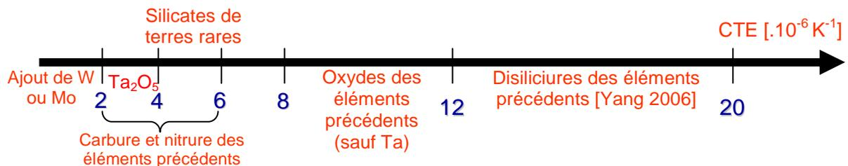
**Figure 1.21** : Variation des coefficients de dilatation thermique en fonction des composés.
