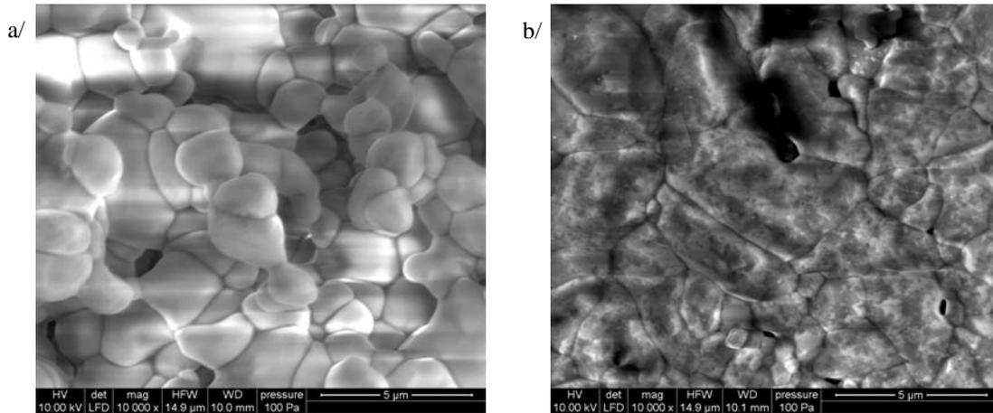
**Figure 4.10** : a/ YAG + SiC (50 % molaire) ; b/ YAM + SiC (50 % molaire) suite à un traitement thermique à 1400°C pendant 300 heures sous air humide (50 kPa d'eau à  $P_{atm}$ ).
