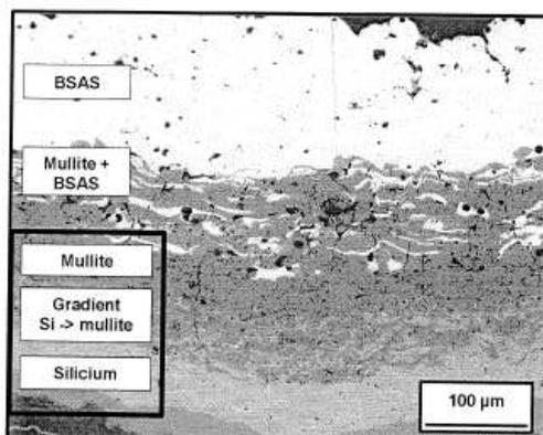
**Figure 2.4** : Section d'un dépôt de référence à base de BSAS avec un gradient de composition Si  $\rightarrow$  mullite intégré [Louchet 2007].
