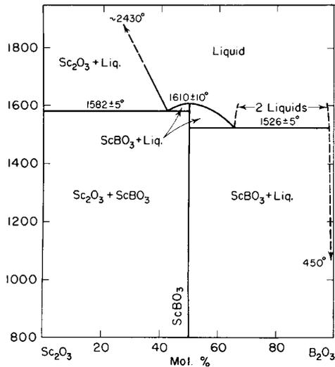
**Figure 24 :** Diagramme de phases  $\text{Sc}_2\text{O}_3$  –  $\text{B}_2\text{O}_3$ .
