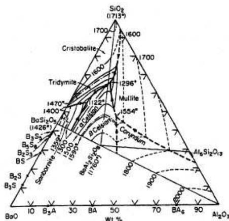
**Figure 11** : Diagramme de phases  $\text{Al}_2\text{O}_3\text{-BaO-SiO}_2$ .
