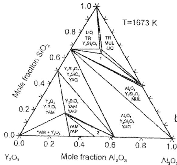
**Figure 6.15** : Diagramme de phases  $\text{Y}_2\text{O}_3\text{-Al}_2\text{O}_3\text{-SiO}_2$  à 1400°C.
