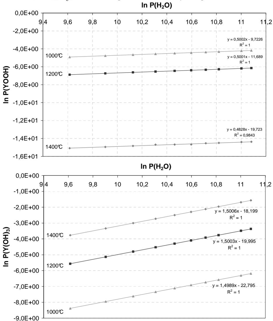
**Figure 5.10** : Détermination des ordres partiels réactionnels associés à  $\text{H}_2\text{O}$  par calculs thermodynamiques à l'aide de Gemini2 pour valider les enthalpies libres de formation de YOOH et  $\text{Y}(\text{OH})_3$  (avec P en Pa).
