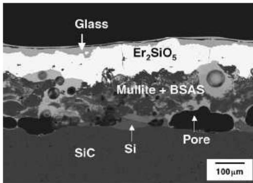
**Figure 2.6** : Section d'un revêtement à base de silicate d'erbium / mullite + BSAS / Si sur SiC après 100 heures de corrosion à  $1400^\circ\text{C}$  (90 kPa  $\text{H}_2\text{O}$ , 10 kPa  $\text{O}_2$ ) [Lee 2005b].
