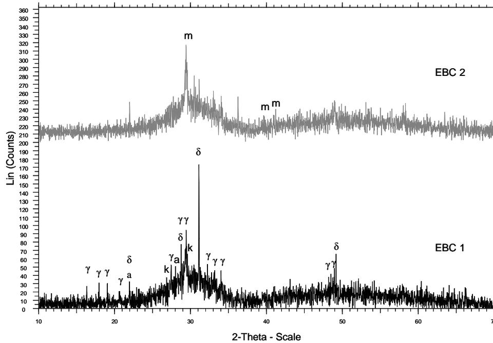
**Figure 6.5** : Diffractogrammes des EBC 1 et 2 brutes.
