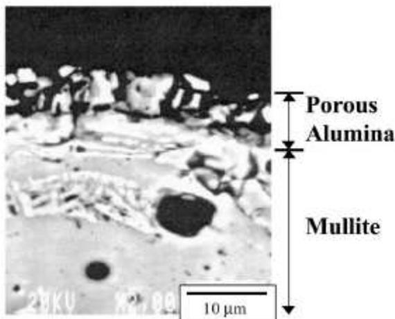
**Figure 2.2** : Section d'un revêtement de mullite après essai de corrosion dans le burner rig (50 h,  $1230^\circ\text{C}$ , 6 atm, equivalent ratio = 1,9, vitesse des gaz =  $2000 \text{ cm.s}^{-1}$ ) [Lee 2000]
