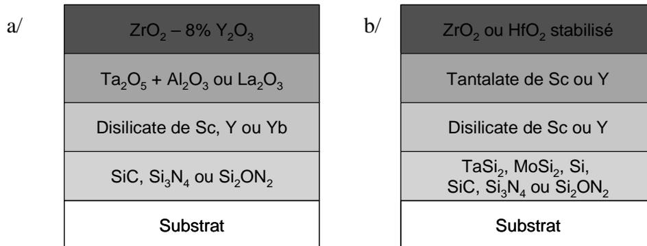
**Figure 2.10** : Barrières environnementales à base d'oxyde de tantale et de silicate de terre rare [Raybould 2005, Raybould 2006].
