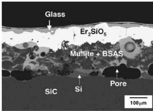
**Figure 13** : EBC à base de silicate d'erbium [Lee 2005b].
