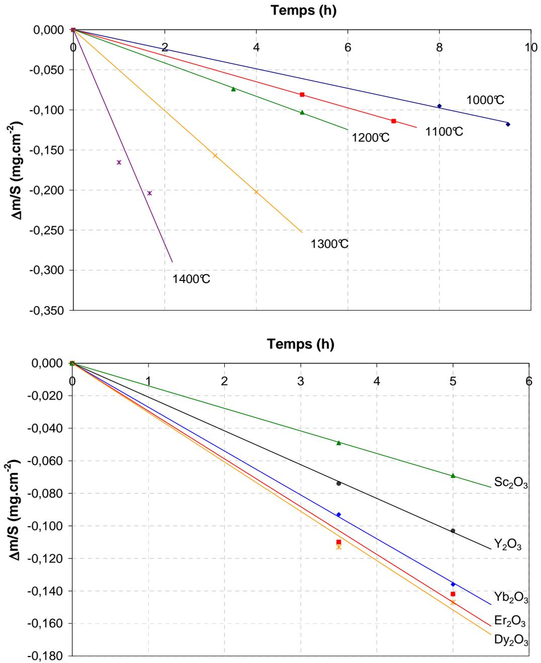
**Figure 5.5** : Constantes de volatilisation quantifiées par suivi de la perte de masse de a/  $Y_2O_3$  à différentes températures et b/  $RE_2O_3$  à 1200°C ( $P_{H_2O} = 50$  kPa,  $P_{tot} = P_{atm}$ ,  $v_{gaz} = 5$  cm.s<sup>-1</sup>).
