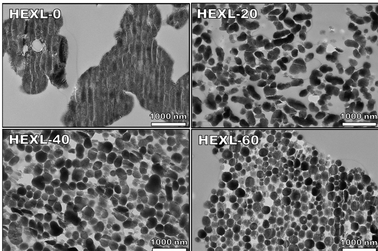
Figure 39 : clichés MET de coupes de matériaux calcinés de mésostructure hexagonale, synthétisés avec un assemblage {POE<sub>10000</sub>-*b*-PAA<sub>2880</sub> + PAM<sub>10000</sub>-*b*-PAA<sub>2880</sub> + OC2500} à pH=4,5 à différents taux de polymère PAM-*b*-PAA.
