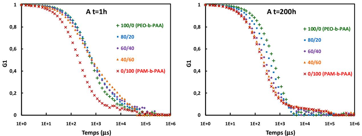
Figure 99 : corrélogrammes DLS normalisés des solutions de micelles PIC avec un ratio PEO-*b*-PAA/PAM-*b*-PAA variable. A gauche sont représentés les résultats obtenus 1h après la préparation des solutions et à droite les résultats obtenus sur les mêmes solutions après 200h de repos.
