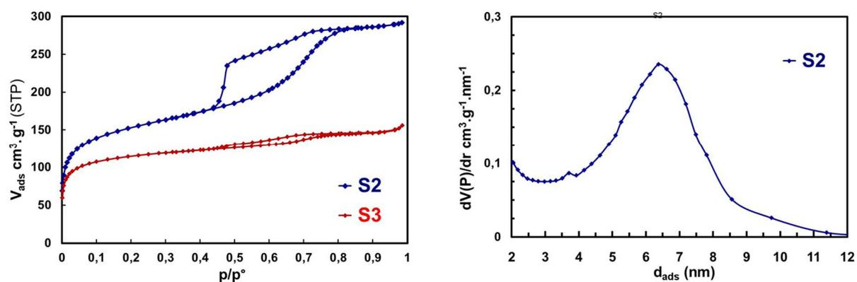
Figure 80 : isothermes de sorption de diazote (gauche) des matériaux calcinés S2 et S3 et distribution de taille de pores à l'adsorption (droite) de S2. S2 est synthétisé avec le PAPOE<sub>12400</sub>-*b*-PSSNa<sub>4400</sub> et S3 avec le POE<sub>9200</sub>-*b*-PSSNa<sub>5000</sub>
