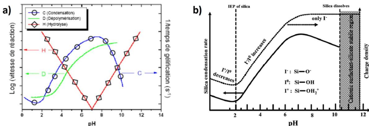
Figure 2 : a) schéma des vitesses d'hydrolyse et de condensation des précurseurs siliciques en solution aqueuse suivant le pH<sup>16</sup> b) cinétique de condensation et état de charge des espèces siliciques en solution aqueuse en fonction du pH<sup>17</sup>
