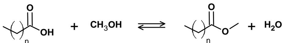
Figure 87 : réaction d'estérification d'acide gras par le méthanol
