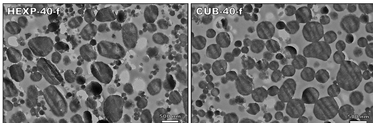
Figure 76 : clichés MET des coupes des matériaux fonctionnels lavés *in situ* synthétisés avec 40% de PAM-*b*-PAA. HEXP-40-f est formé avec un assemblage {PAPOE<sub>10000</sub>-*b*-PAA<sub>2880</sub> + PAM<sub>10000</sub>-*b*-PAA<sub>2880</sub> + OC7500} à pH=5,0 ; CUB-40-f avec {PAPOE<sub>10000</sub>-*b*-PAA<sub>2880</sub> + PAM<sub>10000</sub>-*b*-PAA<sub>2880</sub> + OC2500} à pH=4,5.
