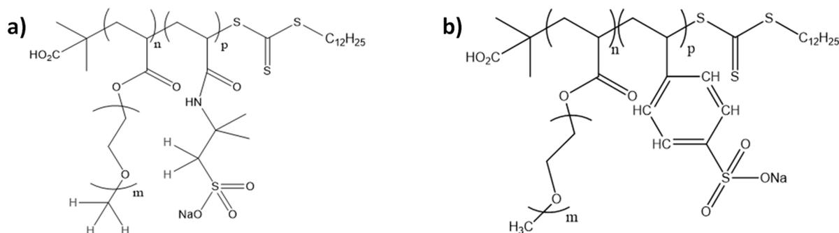
Figure 78 : Formules développées des DHBC avec un bloc polyacide sulfonique
