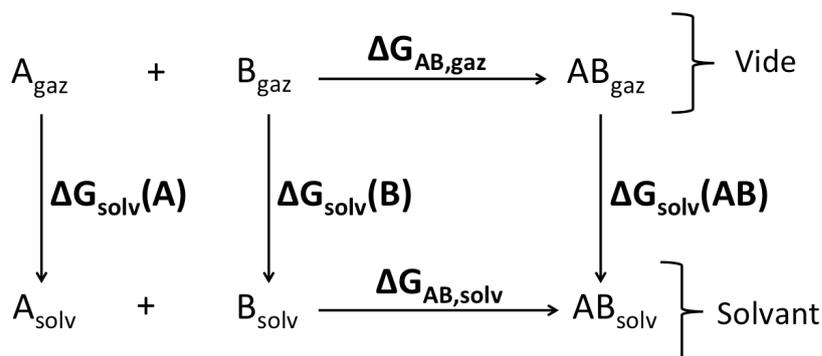
**Figure 46 : Cycle thermodynamique pour calculer l’énergie libre de liaison du complexe AB en solution  $\Delta G_{\text{solv}}(AB)$**
