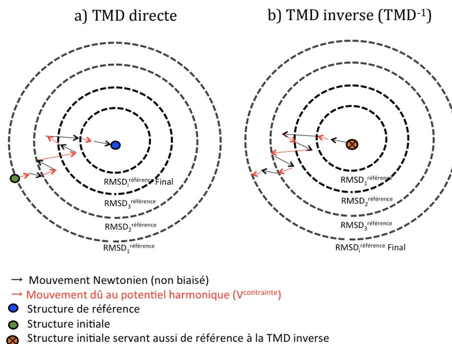
**Figure 45 : Représentation schématique du fonctionnement de la TMD.**
