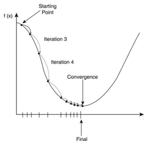
**Figure 43 : Schéma du principe de la minimisation**
