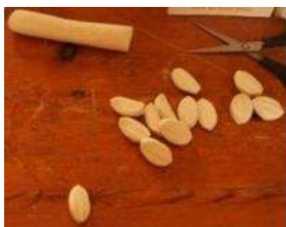
découpage des flans dans une barre - forme en amande
