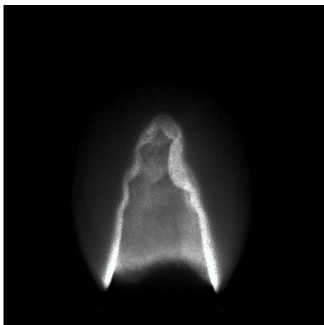
FIGURE IV.3.13 – Image de l'allongement de la flamme Al / air en fin de vie
