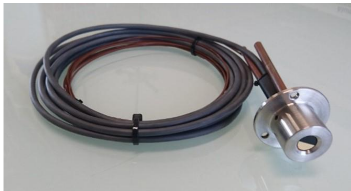
FIGURE III.4.2 – Photo du capteur de flux radiatif avant son montage sur le banc d'essai
