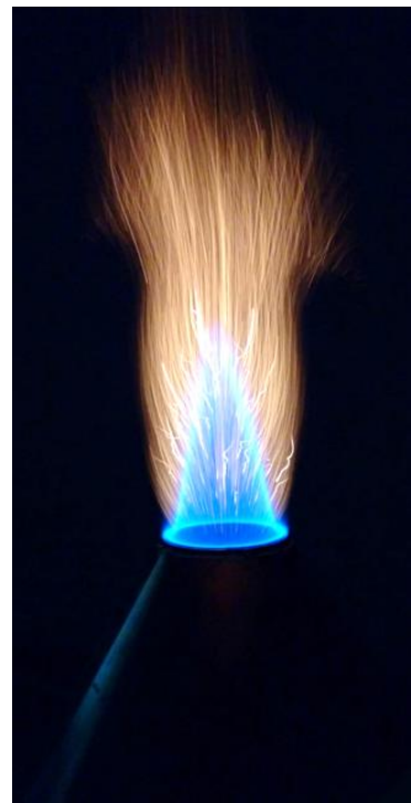
FIGURE III.1.7 – Photo de la flamme prémélangée \text{CH}_4 / air au début de la phase d'ensemencement en particules
