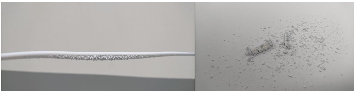
FIGURE IV.2.4 – Photos des produits de combustion collectés par la sonde de prélèvement
