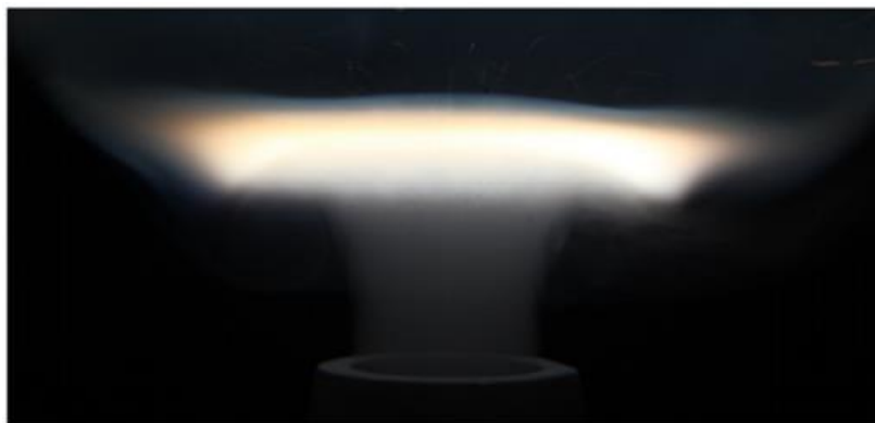
FIGURE II.3.2 – Visualisation directe d'une flamme plate générée à la sortie d'un brûleur et issue d'un prémélange Al / air possédant une richesse de 1,30 (Julien, 2017)
