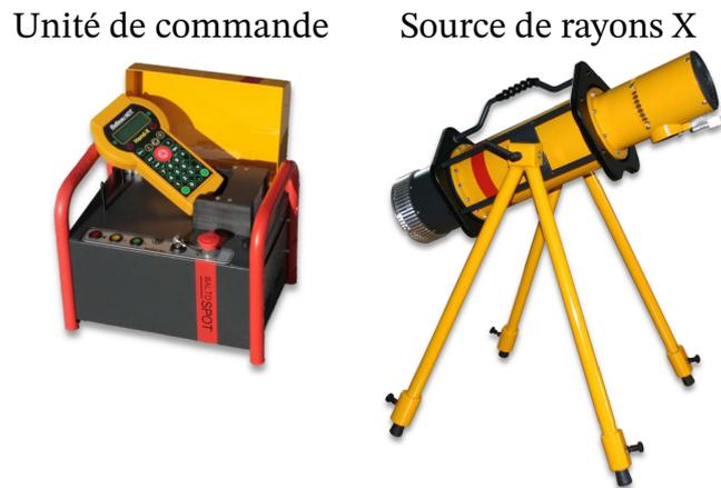
FIGURE 3.2: Unité de commande et de la source de rayons X.
