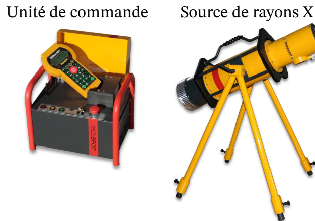
FIGURE 3.2: Unité de commande et de la source de rayons X.
