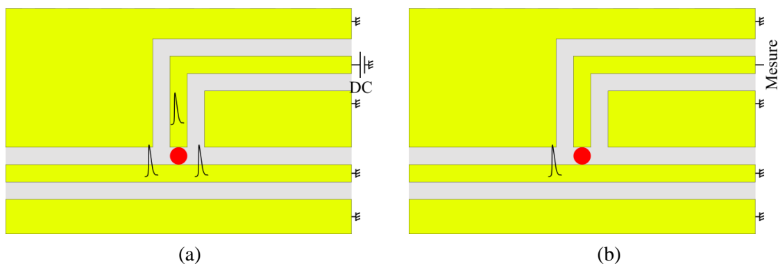
Figure II.16 – Schéma d'un PC bras parallèle en générateur (a) et en détecteur (b)
