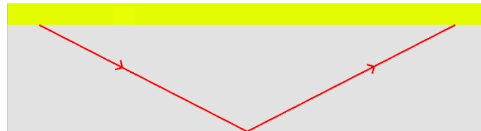
Figure V.16 – Propagation d'un mode de substrat sur la face arrière du substrat de GaAs de 500\ \mu\text{m} d'épaisseur (ligne rouge).
